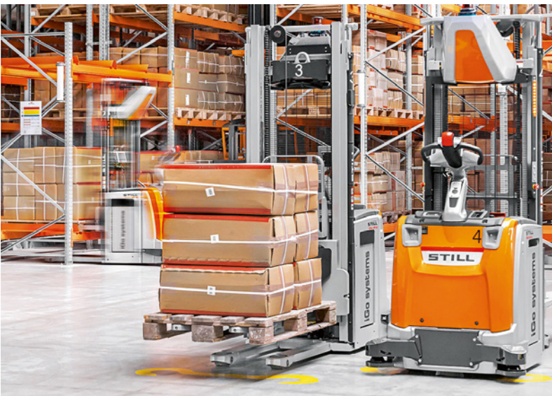
Bild 2a > Das Automated Guided Vehicle im Lager ... (© Still)
